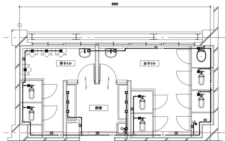
2階トイレ露出給水管図 (撤去) 1:50
