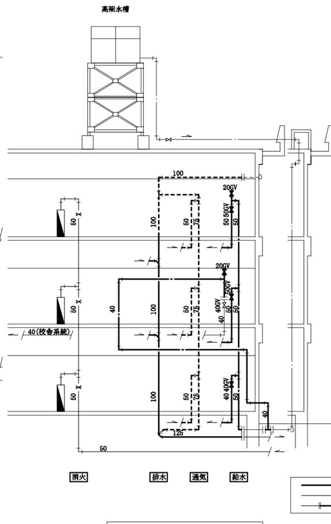
衛生設備系統図(改修後) N.S.
