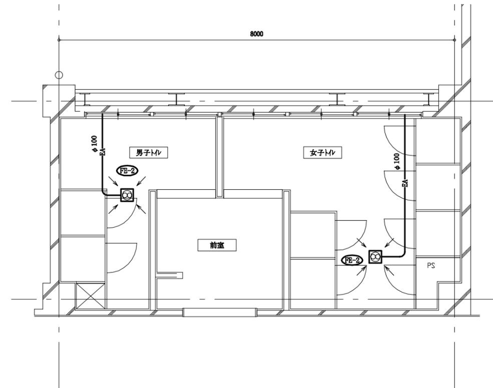
2階・3階トイレ換気設備図(撤去) 1:50
