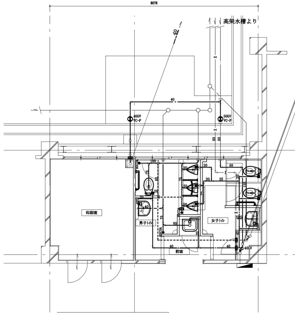
1階トイレ衛生設備図(改修後) 1:50
