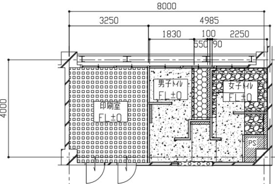
1階印刷室・トイレ床伏図 (改修後) 1/100
