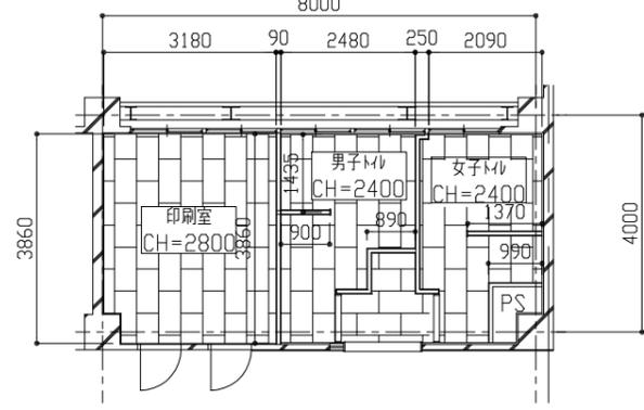
1階印刷室・トイレ天井伏図 (改修後) 1/100
