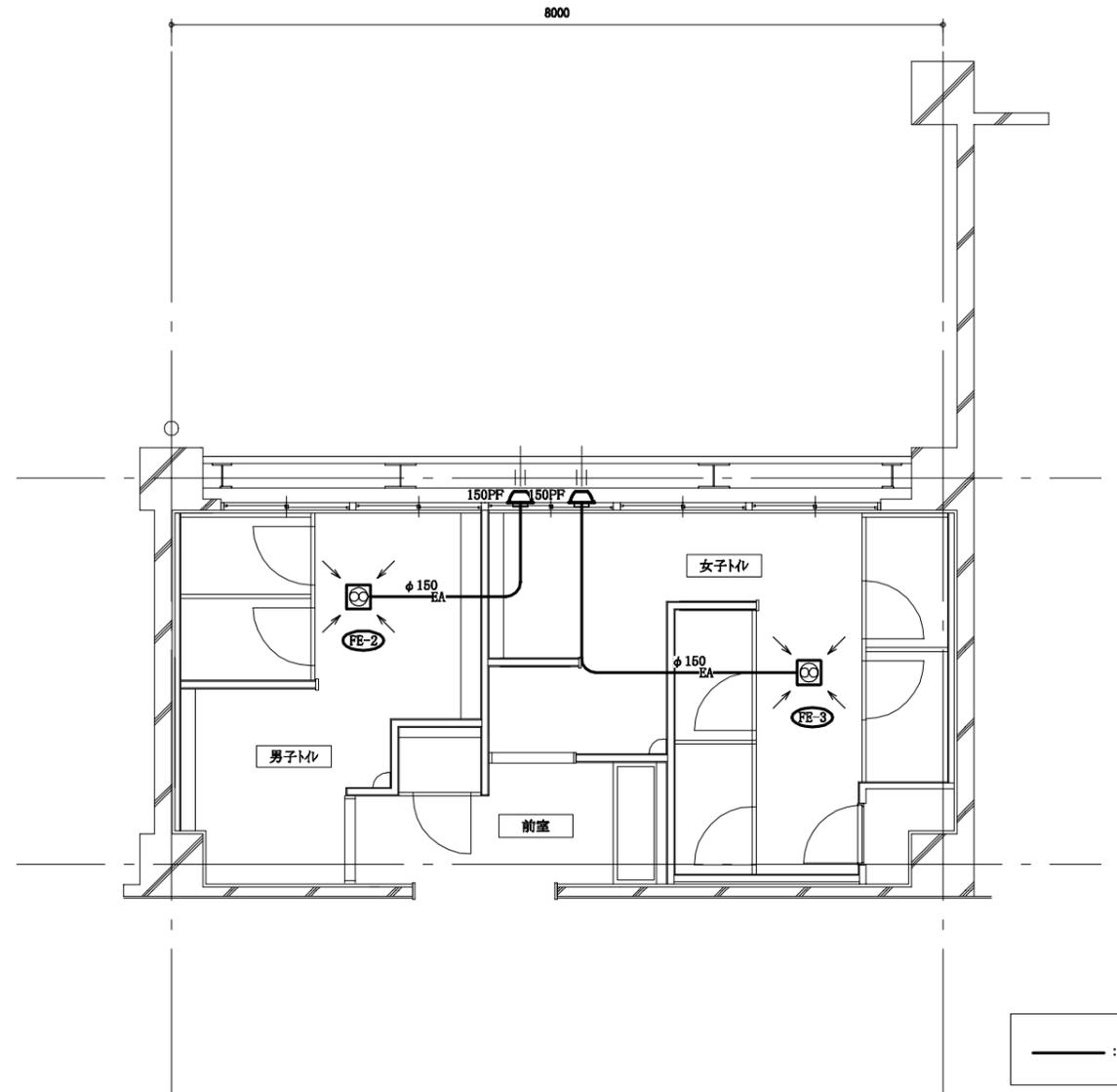
2,3階トイレ換気設備図(改修後) 1:50
