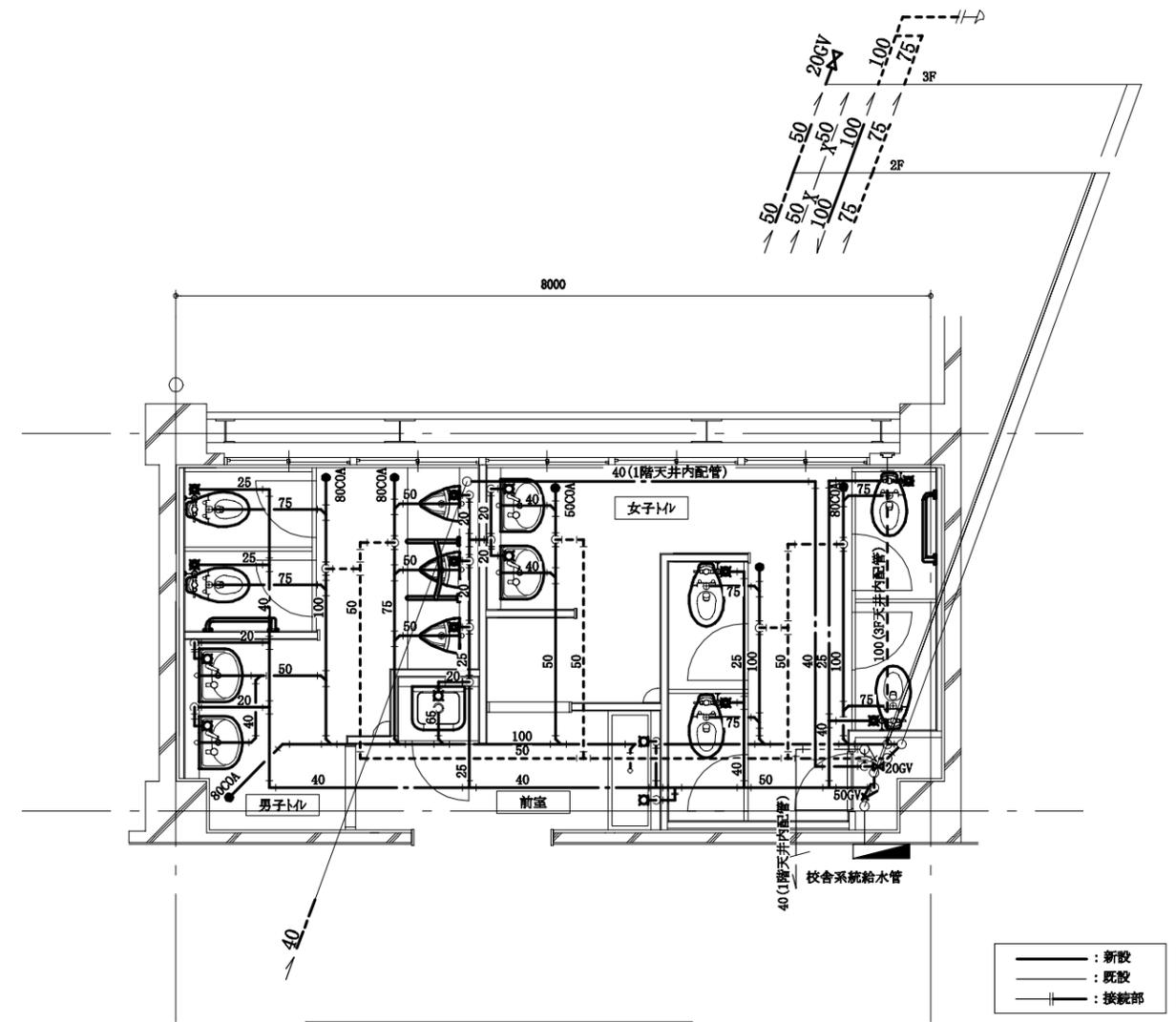
2,3階トイレ衛生設備図(改修後) 1:50
