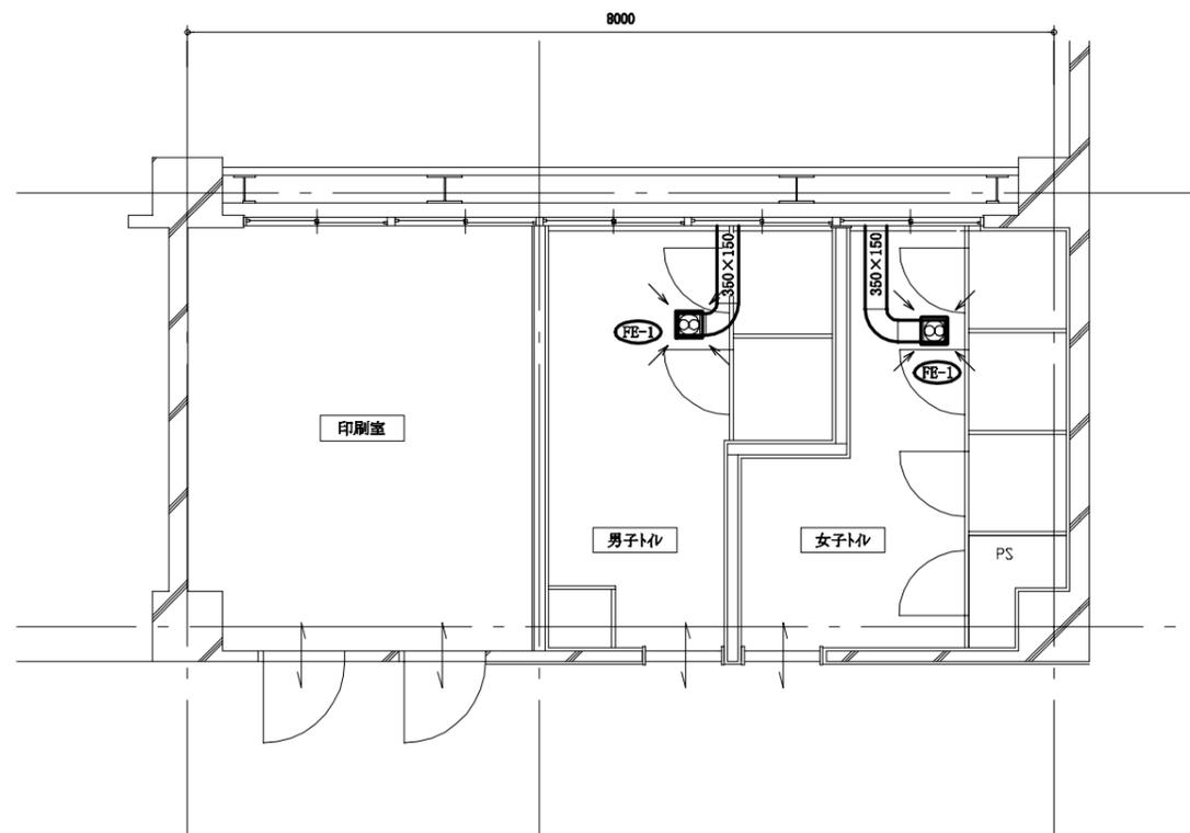
1階トイレ換気設備図(撤去) 1:50
