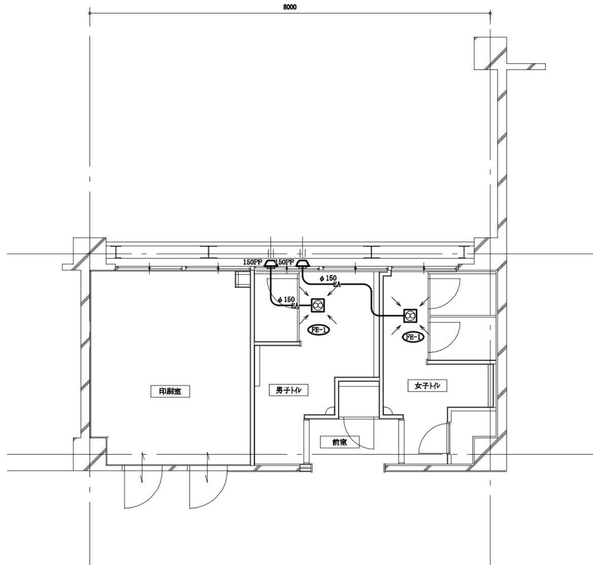
1階トイレ換気設備図(改修後) 1:50
