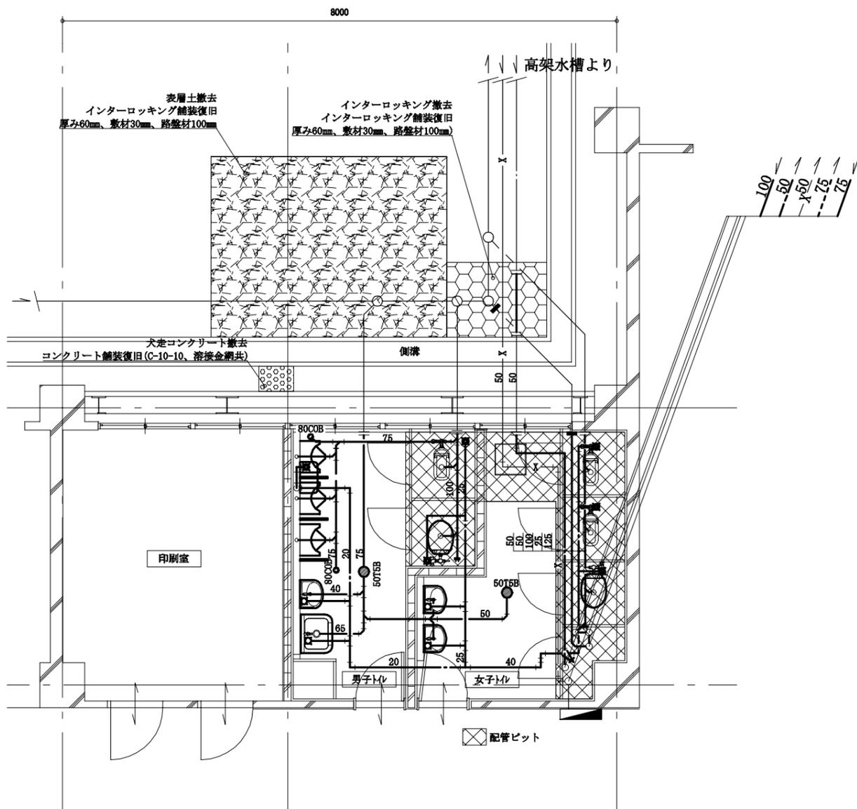
1階トイレ衛生設備図 (撤去) 1:50
