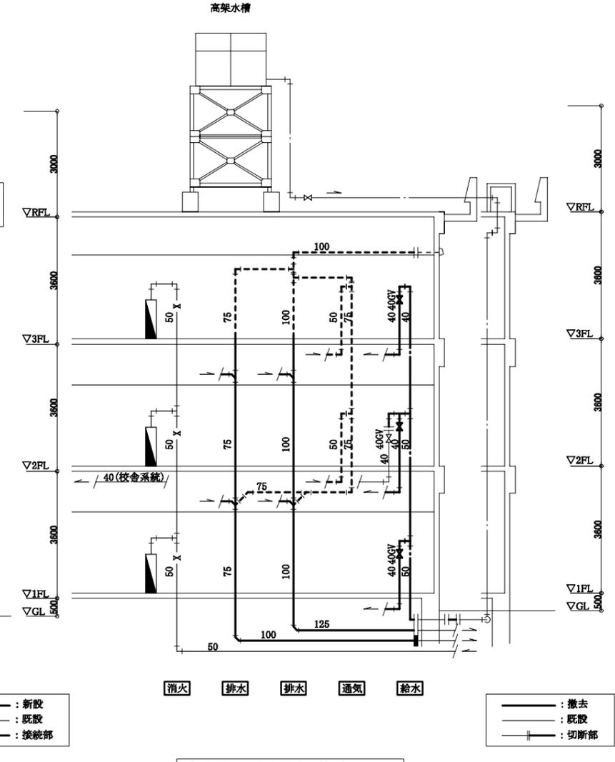
衛生設備系統図(改修前) N.S.
