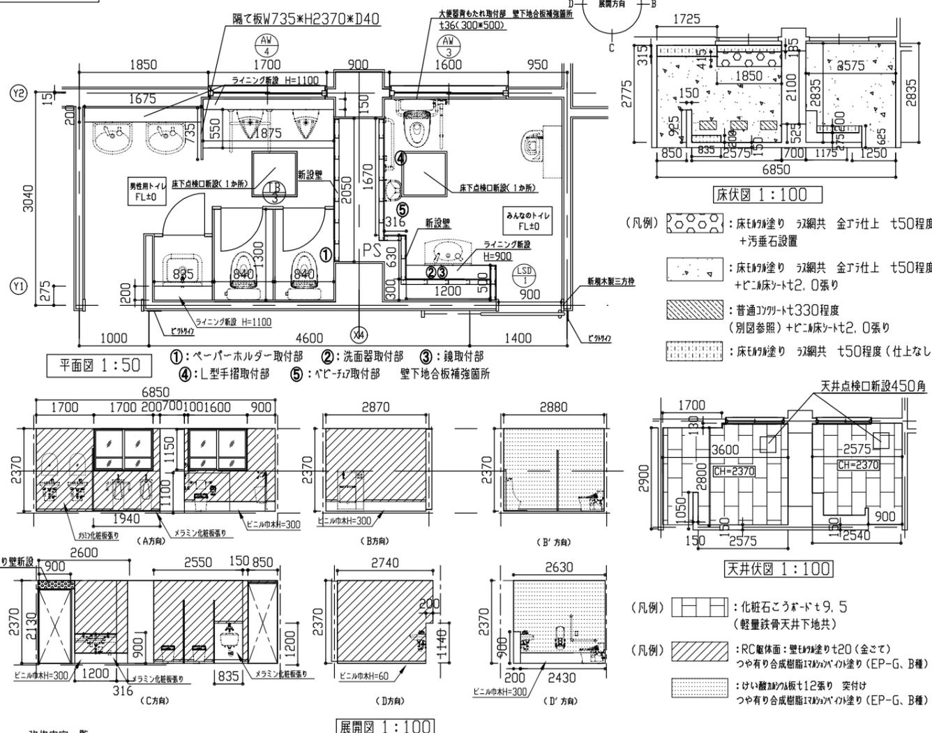
展開図 1:100 (凡例) : 化粧石膏ボードt9.5 (軽量鉄骨天井下地共)
