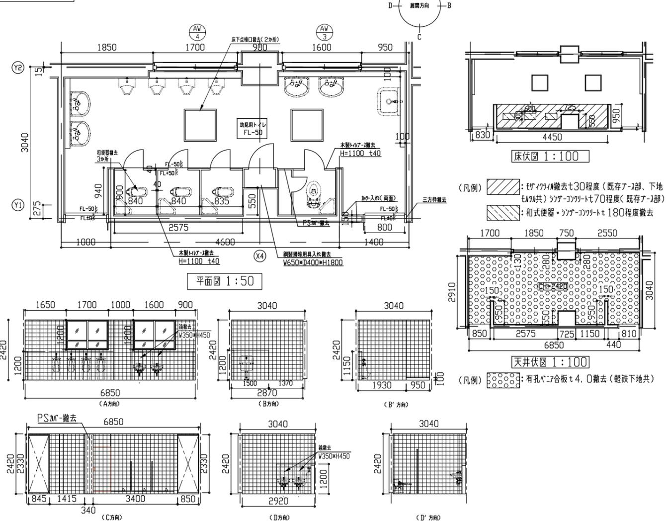
展開図 1:100 (凡例) : 既存100角タテ撤去(下地も共) : PS加-撤去(7尺製、FL+2420まで)
