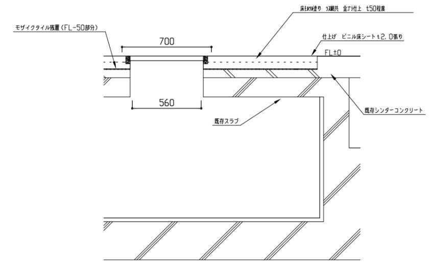
床下点検口断面詳細図 1:20
