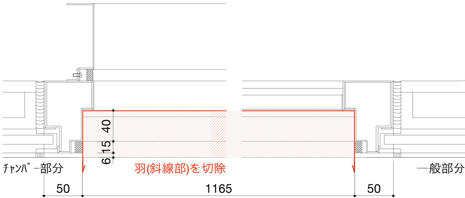
CW L1-06固定ガラリ既存平面詳細図1:5
