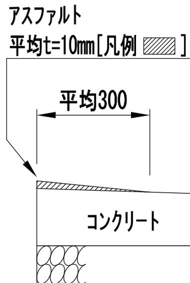
L型側溝補修：エプロン部のオーバーレイ[As]の破碎のみ。
