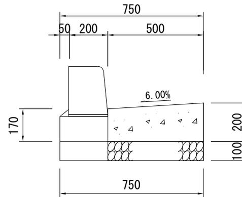
L型側溝エプロン補修材料表
