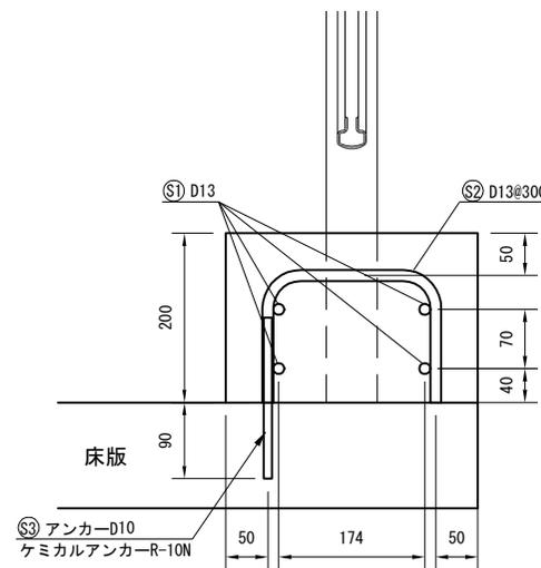
鉄筋詳細図 S=1:20
