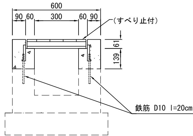
注) 普通目・又はローレット型滑り止め、ツイストバー間隔50mmとする。
