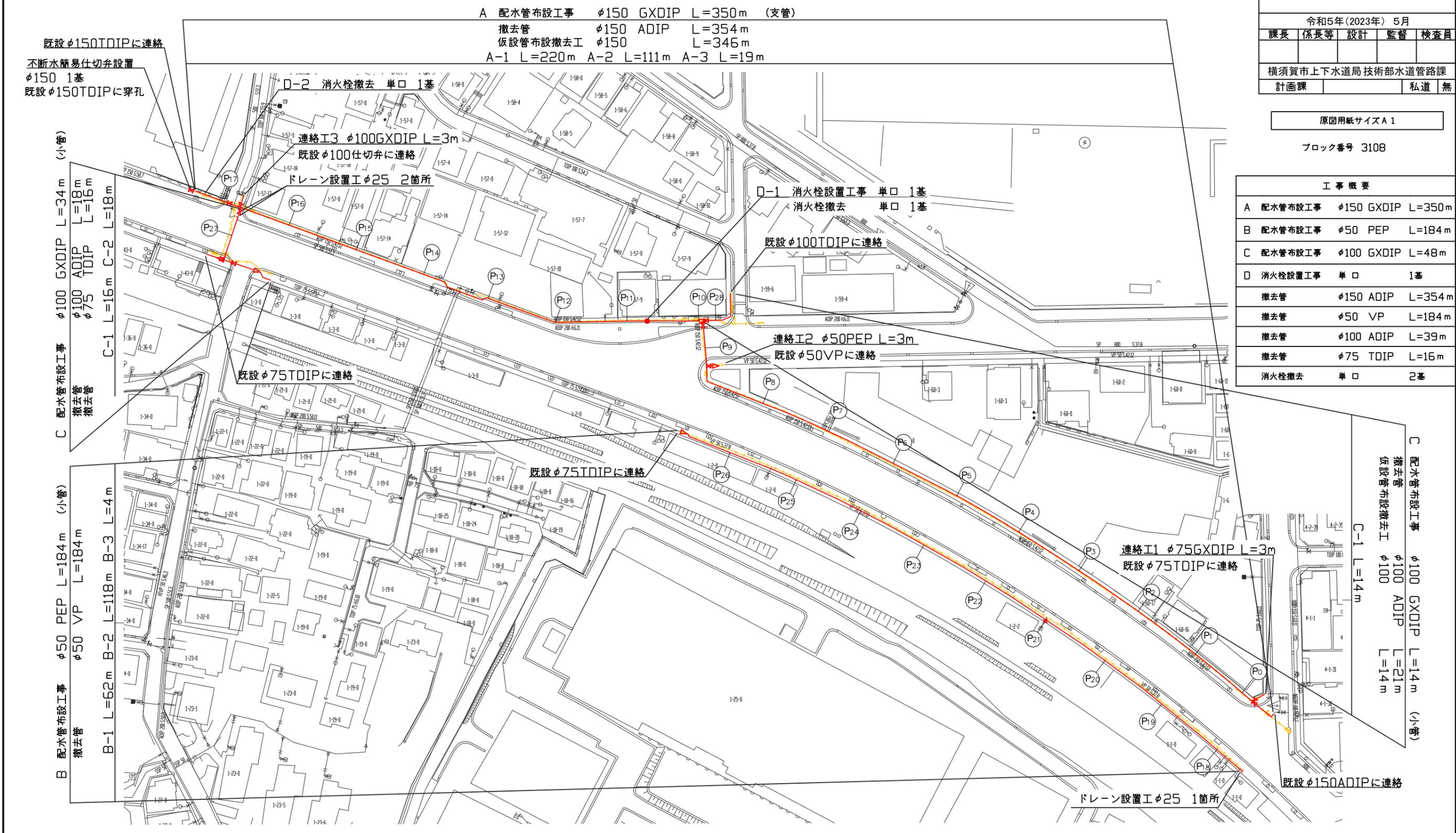
A 配水管布設工事 φ150 GXDIP L=350m (支管)
