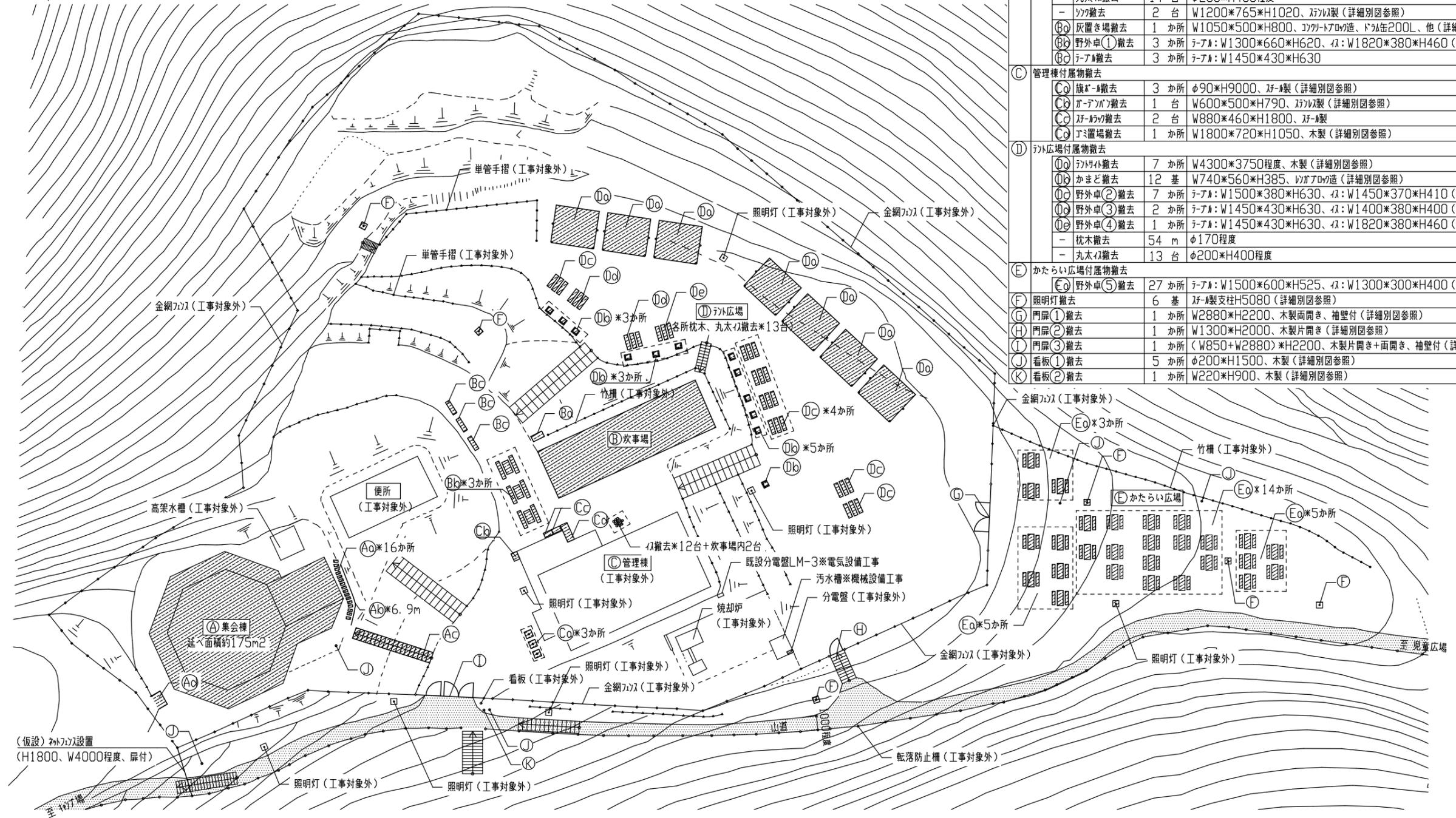
解体撤去一覧(建築工事) (ナリ場は拡大図参照)
