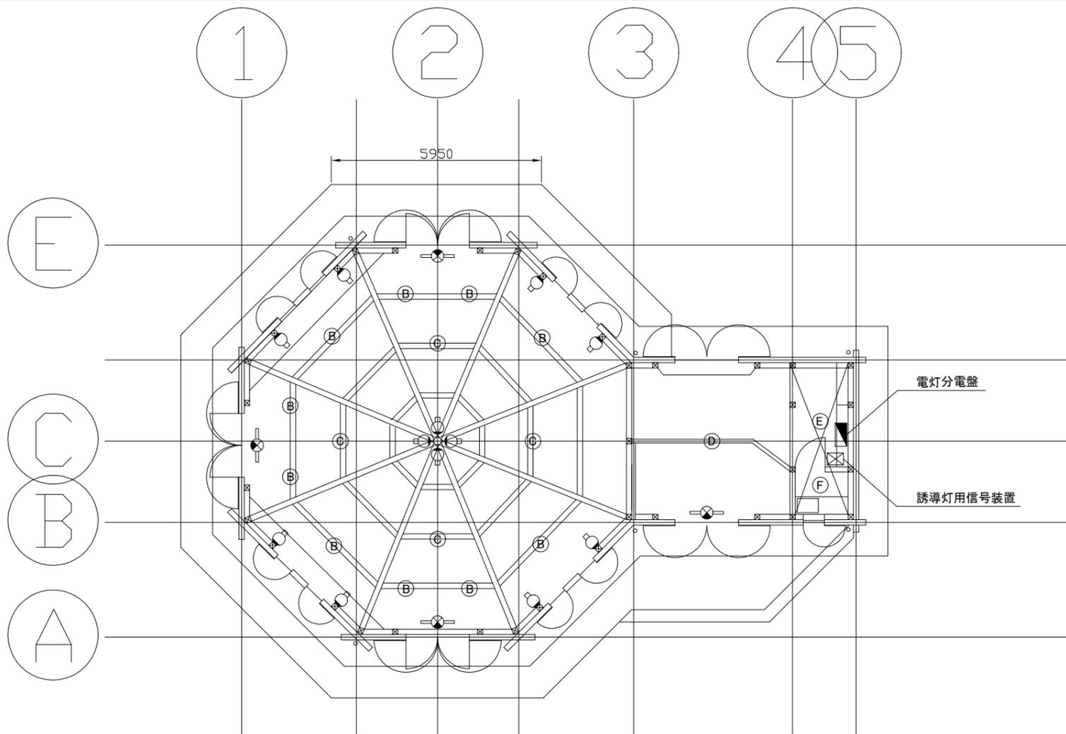
集会棟 電気設備 撤去図 1:100
