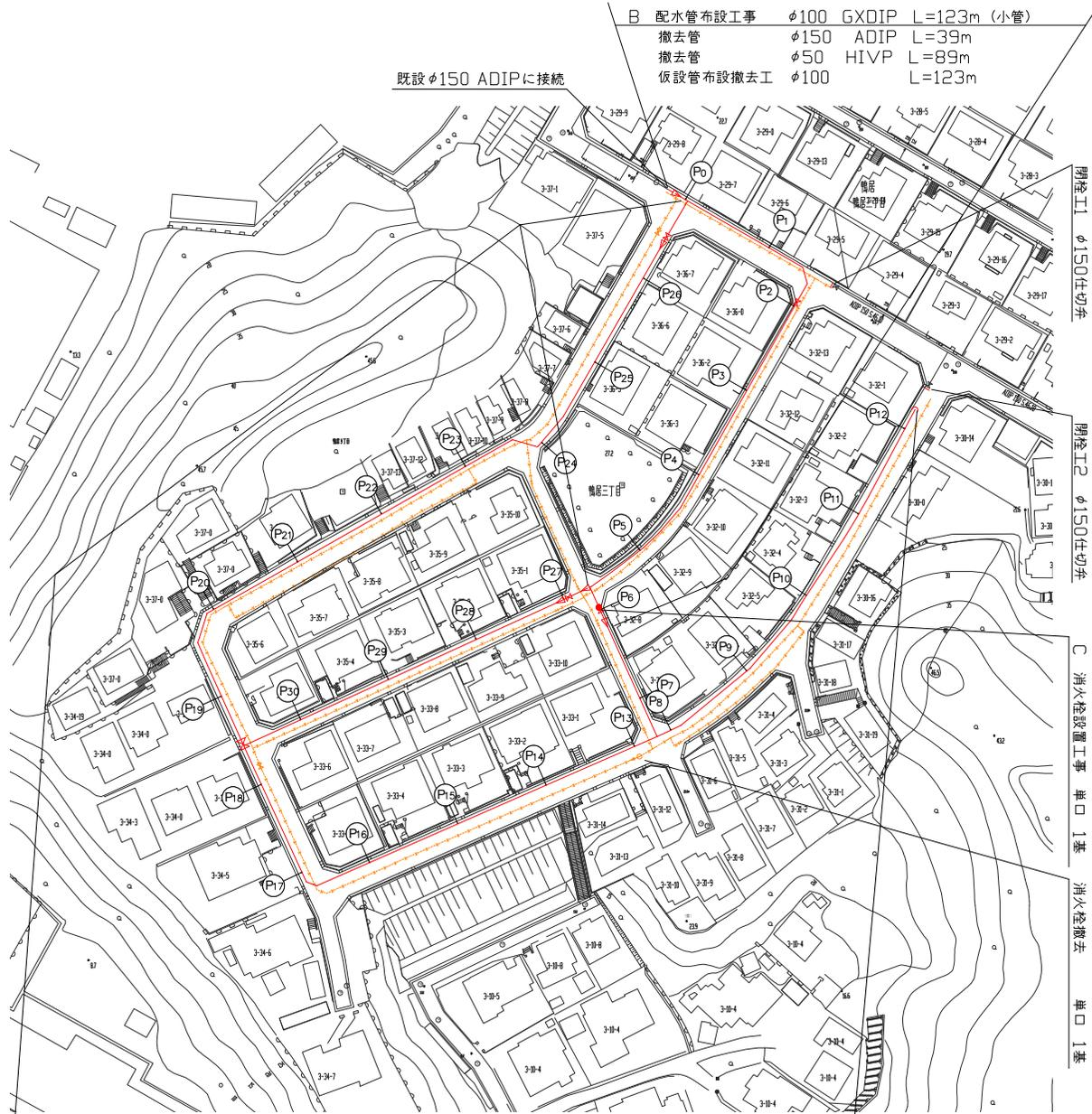
B 配水管布設工事 φ100 GXDIP L=123m (小管)
