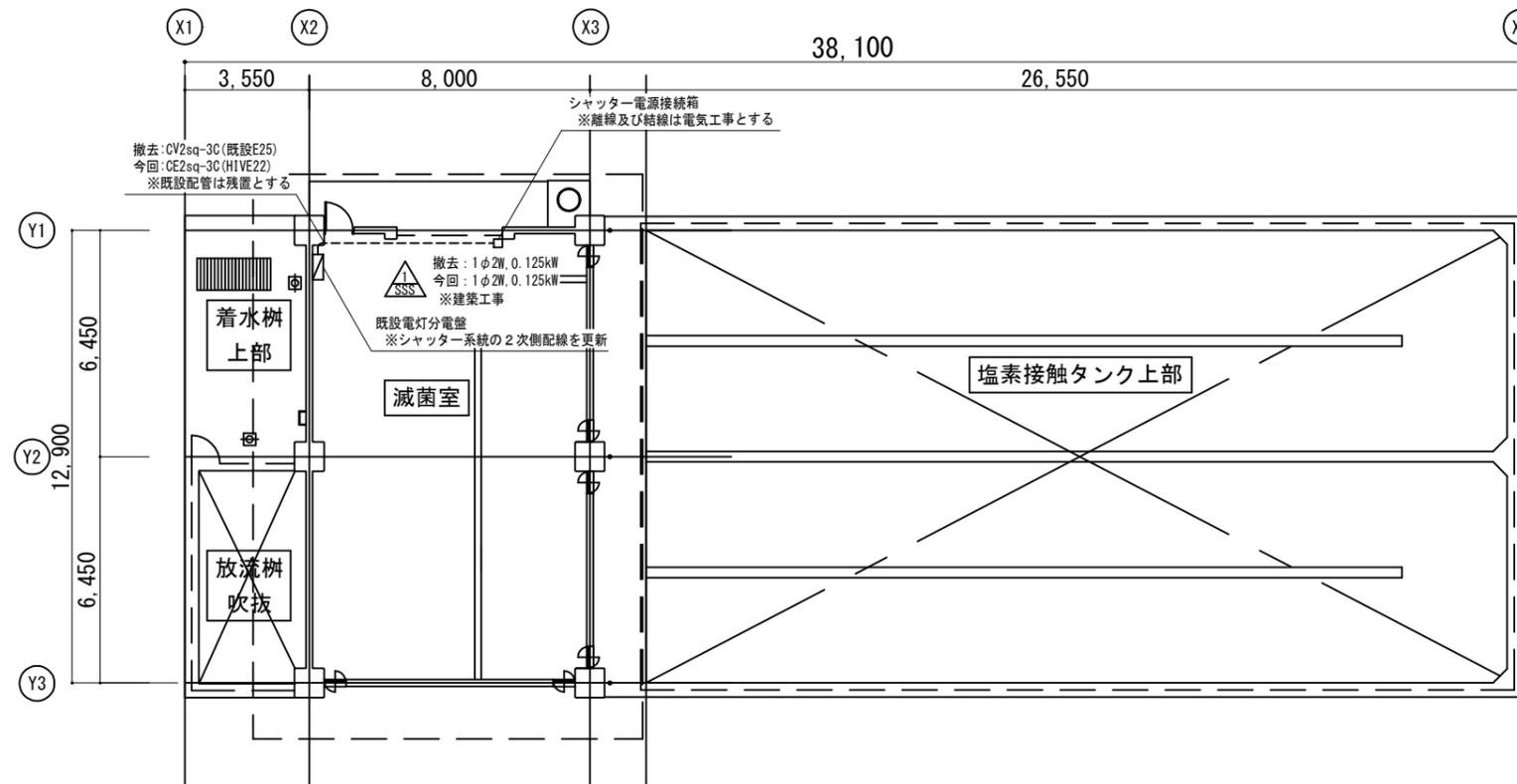
滅菌棟平面図（電気設備） S=1/200
