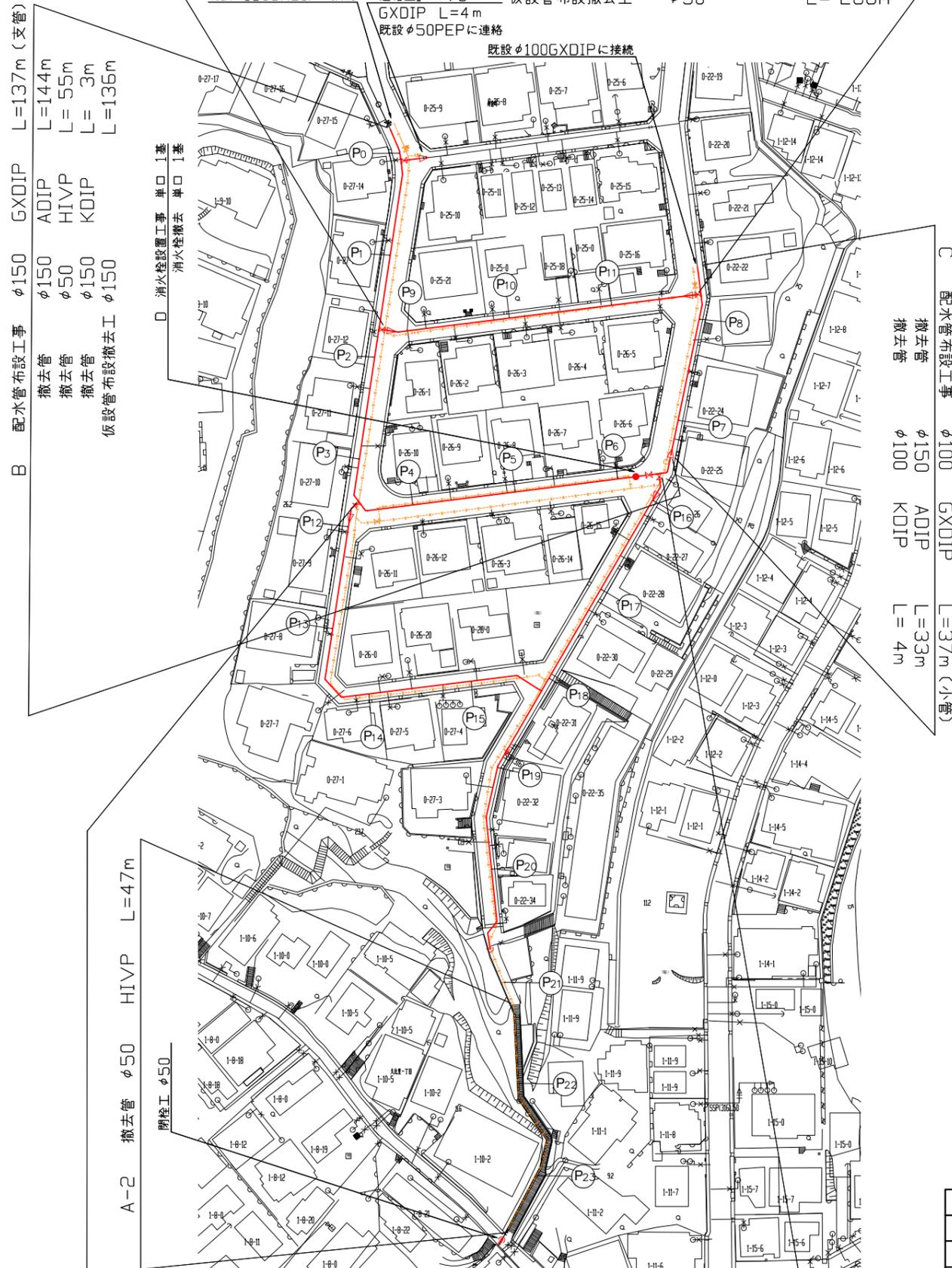
B 配水管布設工事 φ150 GXDIP L=137m (支管)
