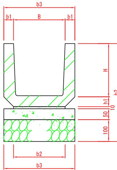
プレキャストU型側溝(コンクリート基礎)
