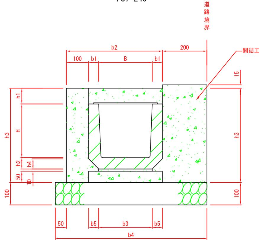
プレキャストU型側溝(舗装止め+間詰、現場打ち蓋付)
