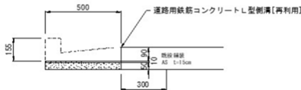
L型側溝補修工
