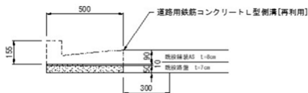
L型側溝補修工
