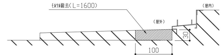
(改修前)掃き出し窓下枠詳細図 1:5
