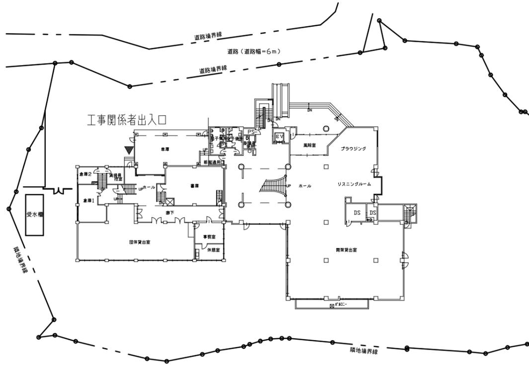
配置図兼1階平面図 1:1000
