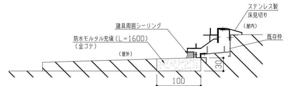
(改修後)掃き出し窓下枠詳細図 1:5
