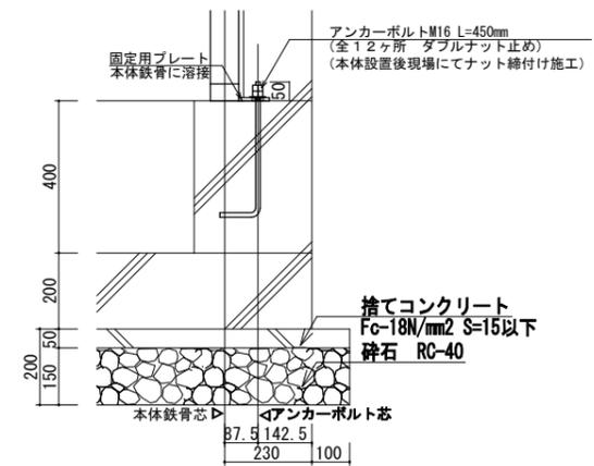
アンカーボルト部詳細図 S = 1 / 15
