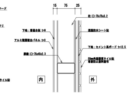
外壁・内壁納まり詳細図 S=1/5
