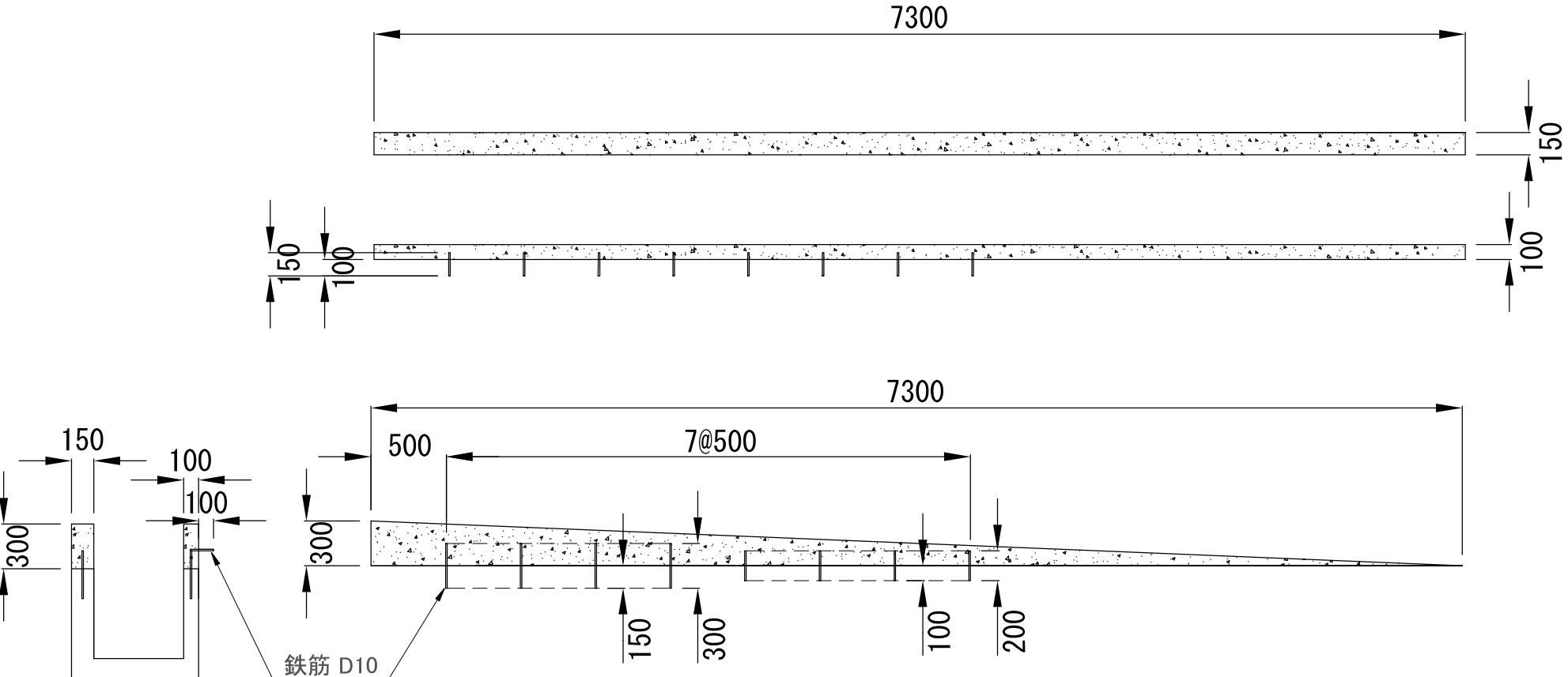
側溝高さ調整工
