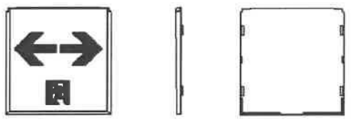
FK20018 (通路誘導灯用表示板)
