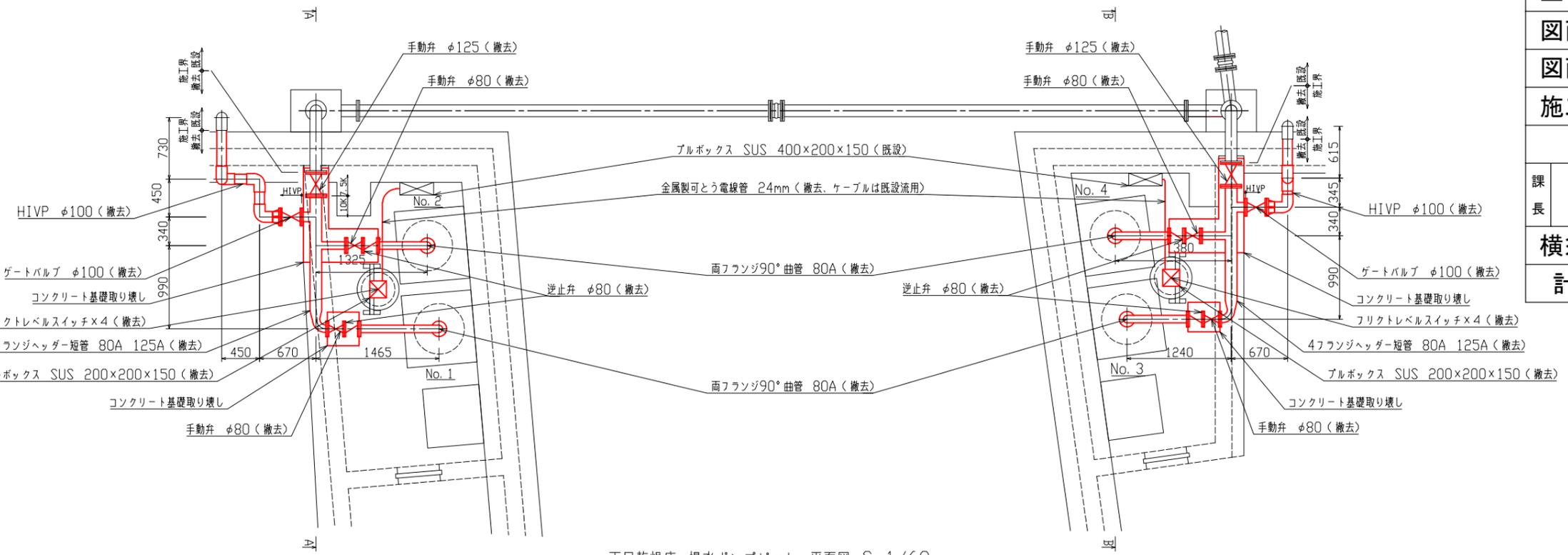
天日乾燥床 揚水ポンプピット 平面図 S=1/60
