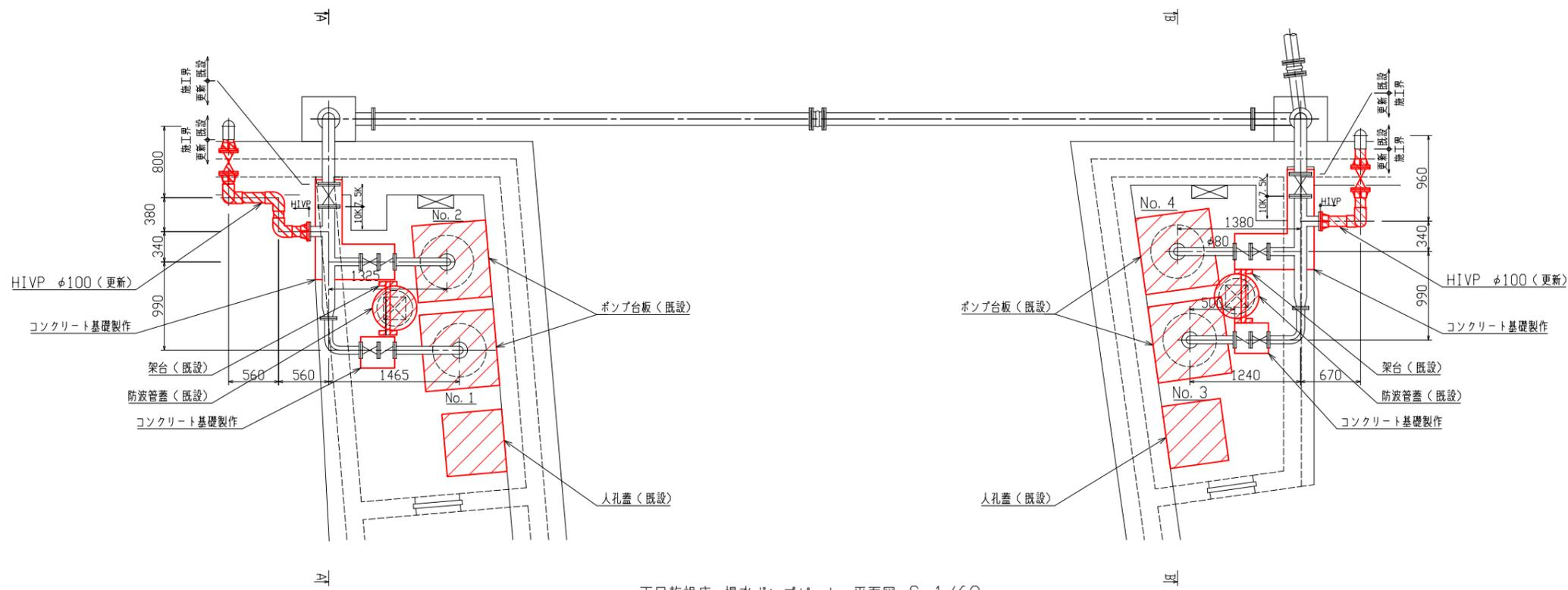
天日乾燥床 揚水ポンプピット 平面図 S=1/60
