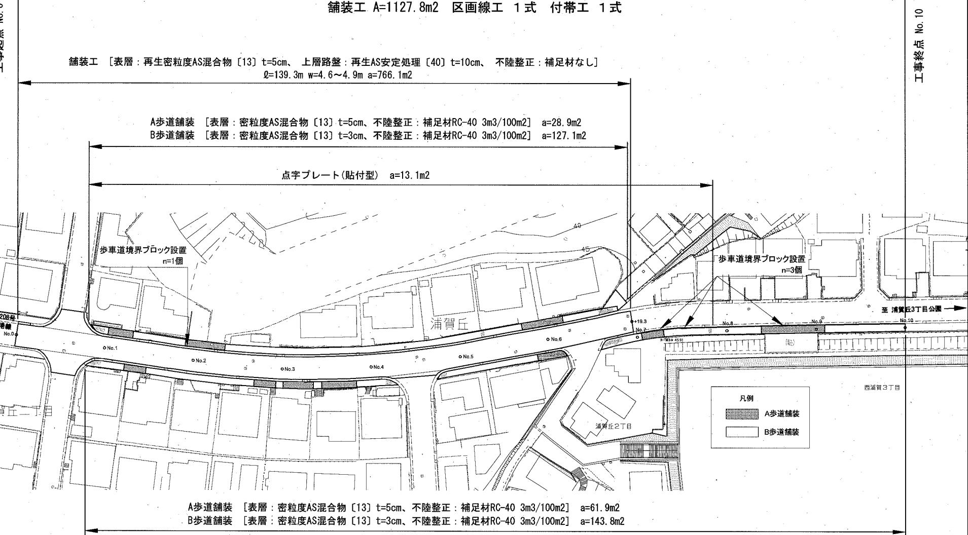
A歩道舗装 【表層：密粒度AS混合物 [13] t=5cm、不陸整正：補足材RC-40 3m<sup>3</sup>/100m<sup>2</sup>] a=61.9m<sup>2</sup>
