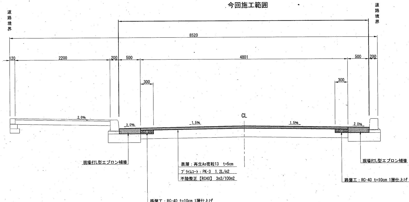
現場打L型側溝エプロン補修構造図
