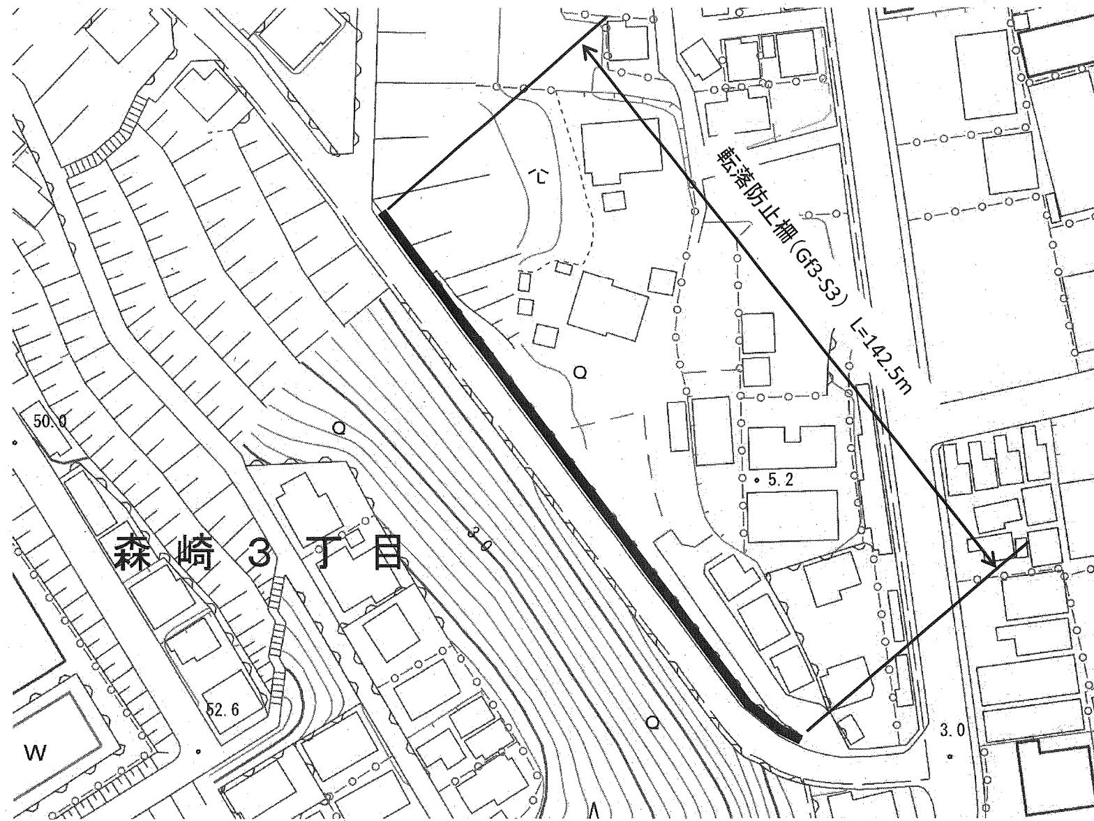
構造図(1) 転落防止柵(ネット型)
