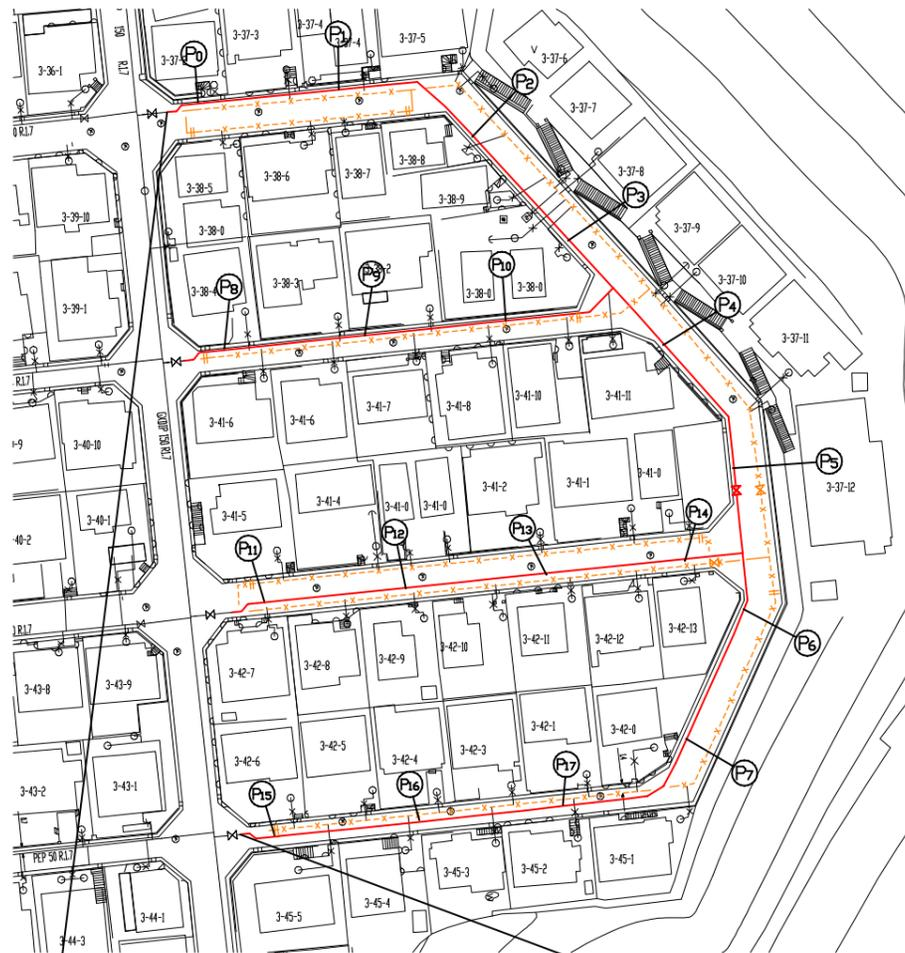
配水管布設工事  $\phi 50$ PEP L=353m (小管)
