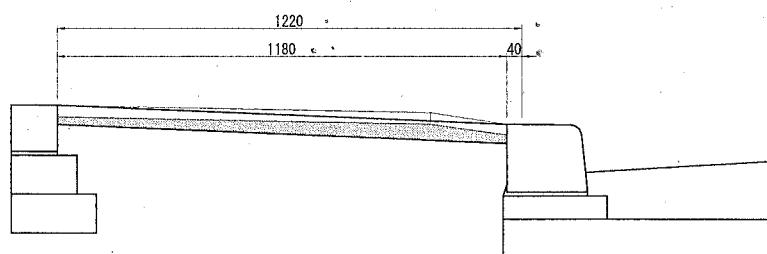
機械掘削 (0.1BH) A=0.037m<sup>2</sup> CAD求積
