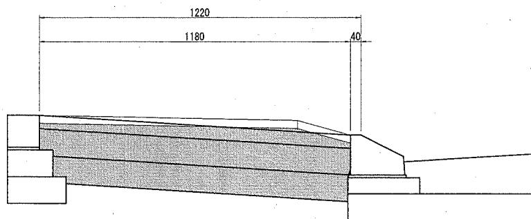
機械掘削 (0.1BH) A=0.276m<sup>2</sup> CAD求積
