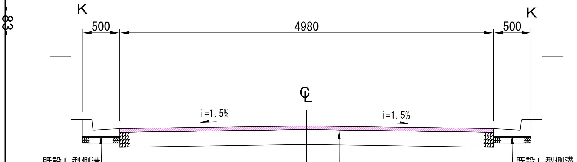
表層：再生密粒度アスファルト混合物[13]  $t=5\text{cm}$
