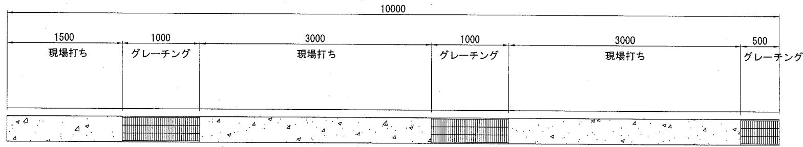
現場打ち集水枠(車道用隣接型)
