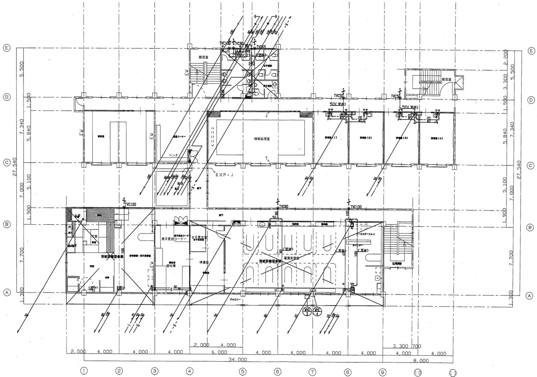
衛生設備 配管3階平面図 S=1:200
