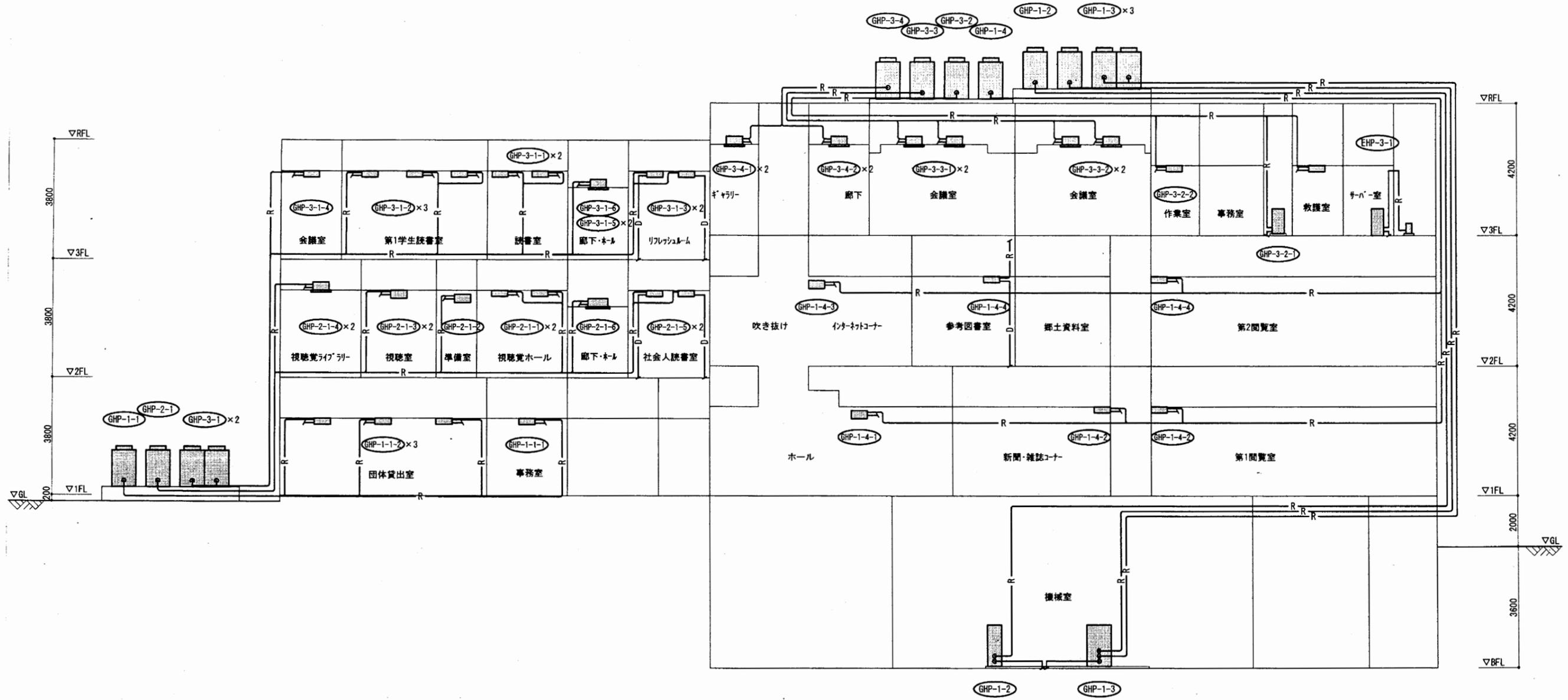
配管系統図(改修)
