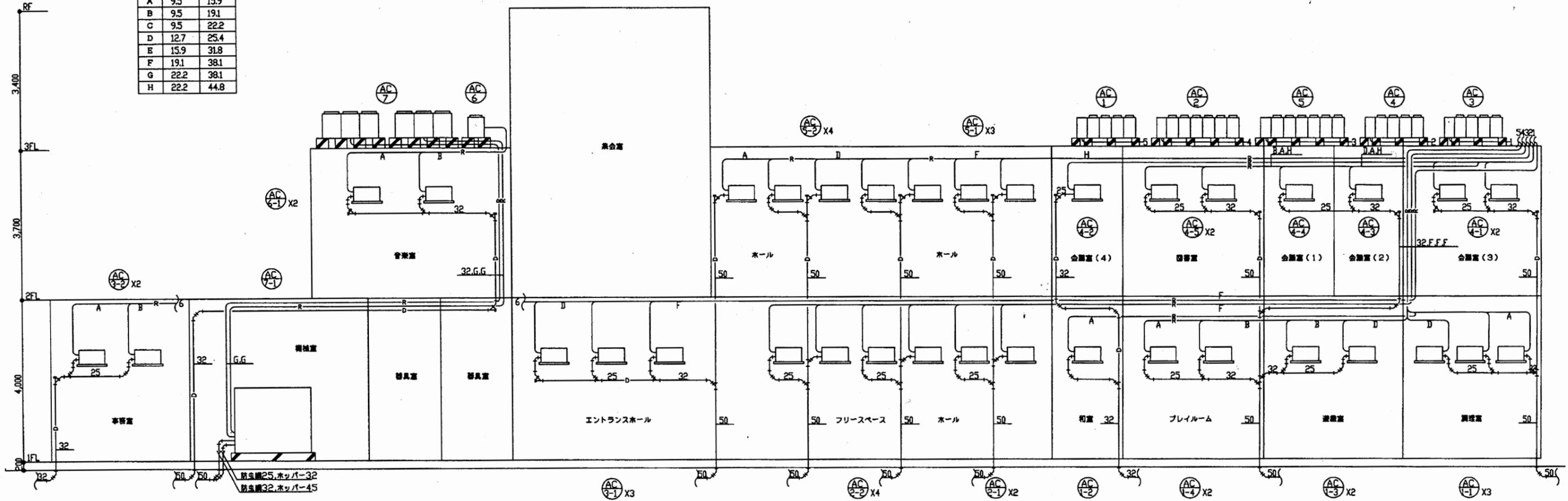
空調設備 配管系統図
