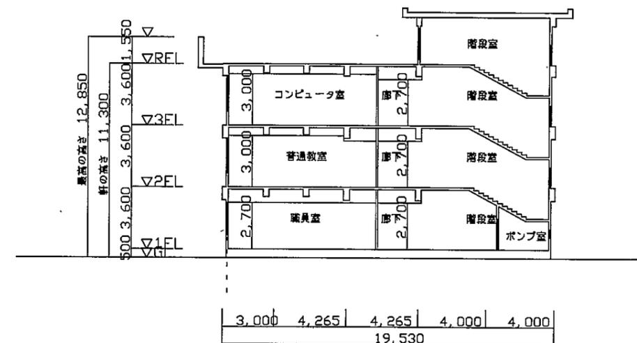
D棟 Y方向 断面図 S1:300
