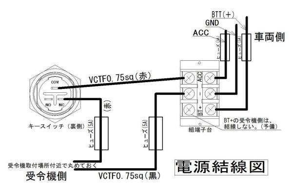
オ 受令機の近くに下図のとおりキースイッチを取付け、表示すること。なお、キースイッチ 端子面(裏側)が点検できる構造とすること。(下図は、ネジと蝶番を用いた構造としている が、これ以外の構造でも構わない。)
