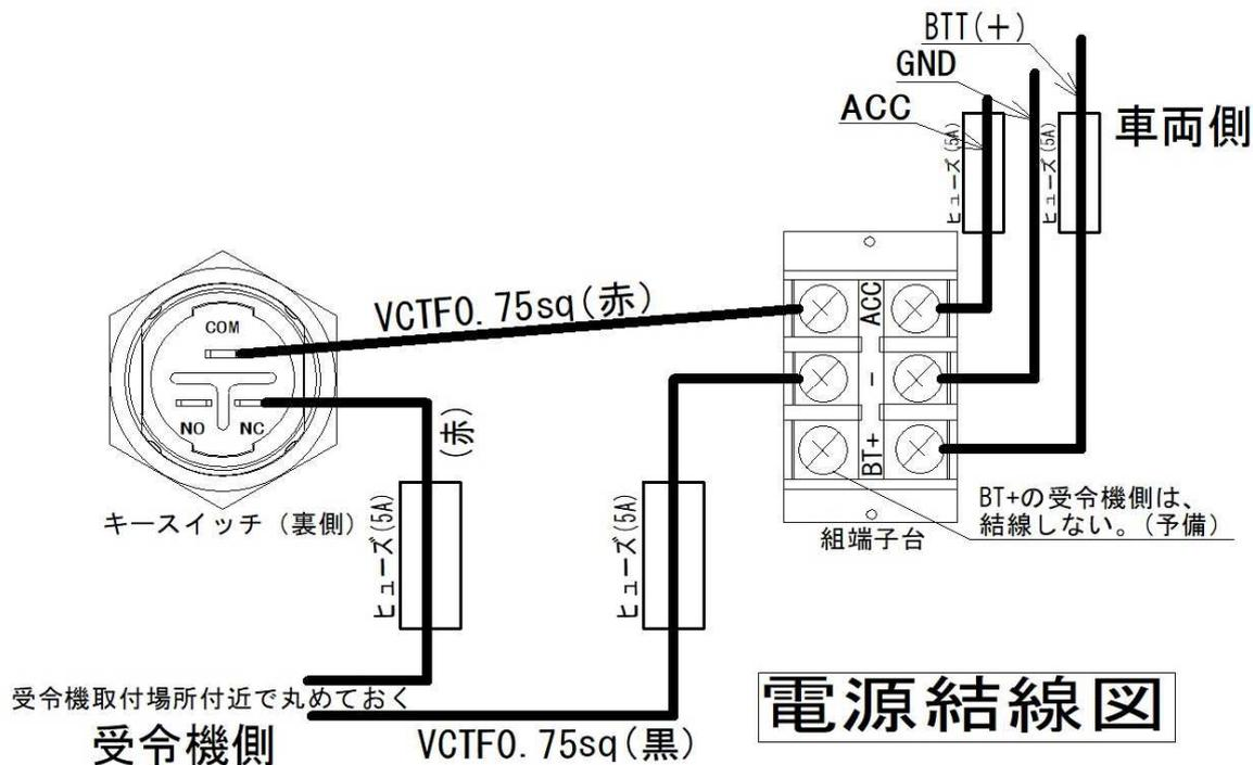
オ 受令機の近くに下図のとおりキースイッチを取付け、表示すること。なお、キースイッチ端子面(裏側)が点検できる構造とすること。(下図は、ネジと蝶番を用いた構造としているが、これ以外の構造でも構わない。)
